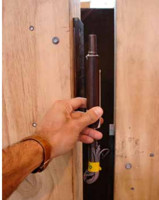
Esempio di dissipatore-fusibile 'Plug&Play'
